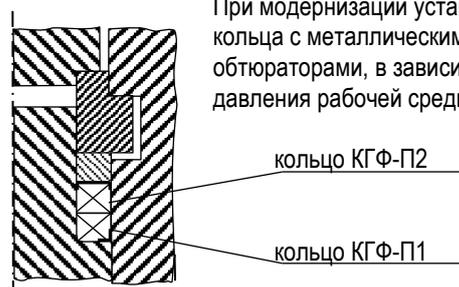
При модернизации устанавливается 1÷2 кольца с металлическими обтюраторами, в зависимости от давления рабочей среды
